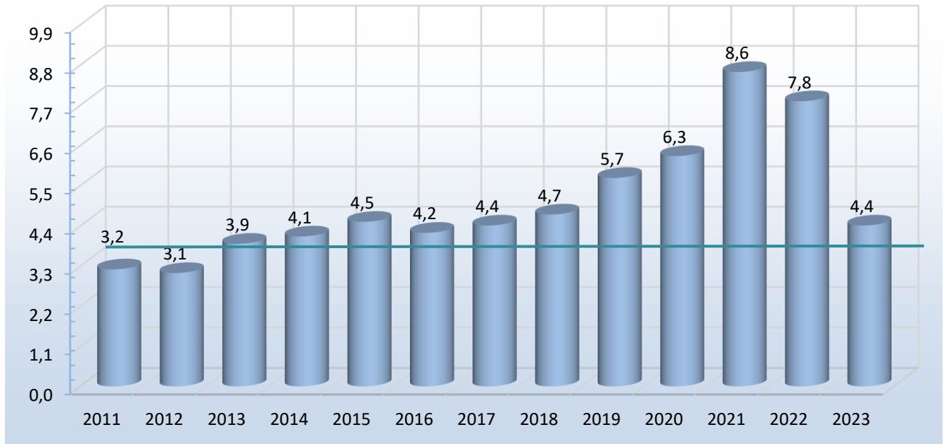
98 pav. Organinių medžiagų (BDS 7 ) vidutinės metų koncentracijos kitimas (V4) Kulpėje ties Pramonės g. 2011 ÷ 2023 m.
