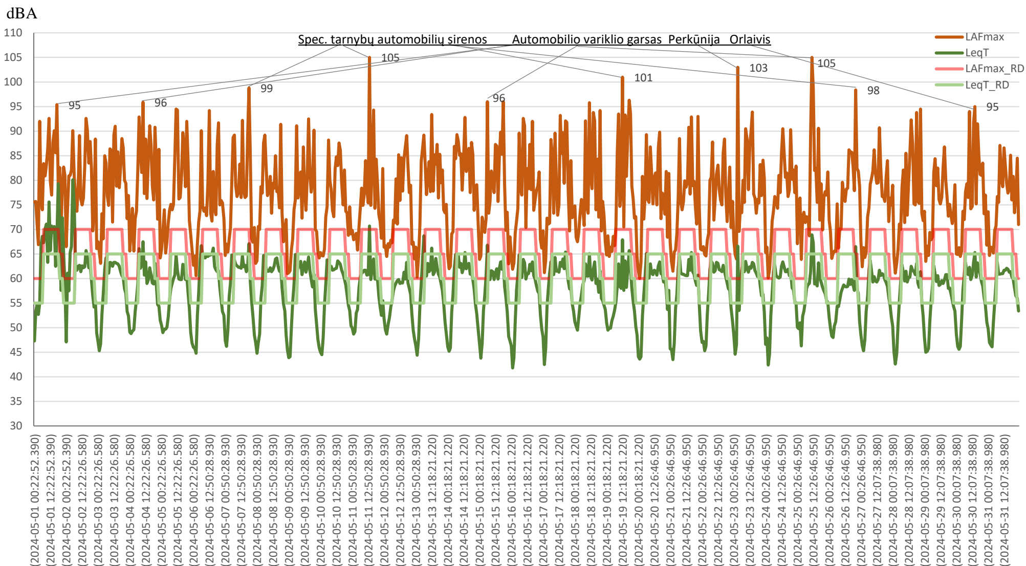
228 pav. Transporto sukeliama triukšmo kitimas pietinėje miesto dalyje, Gegužių g. aplinkoje (Gegužių g. 94), 2024 m. gegužės mėn. 1-31 d. (Maksimalaus triukšmo ribinis dydis dieną 70 dBA, vakare 65 dBA, naktį 60 dBA; ekvivalentinio triukšmo ribinis dydis dieną 65 dBA, vakare 60 dBA, naktį 55 dBA)
