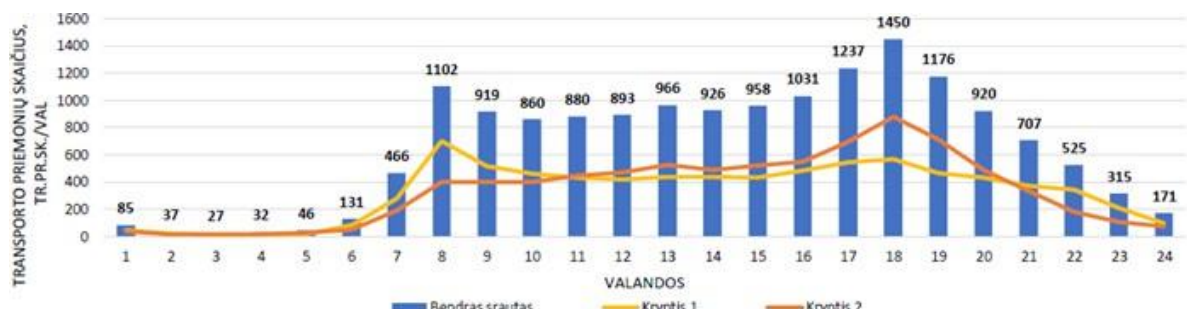
Transporto srautų pasiskirstymas darbo dieną Karaliaučiaus g. (Nr. B) 2020 m. birželio mėn.
