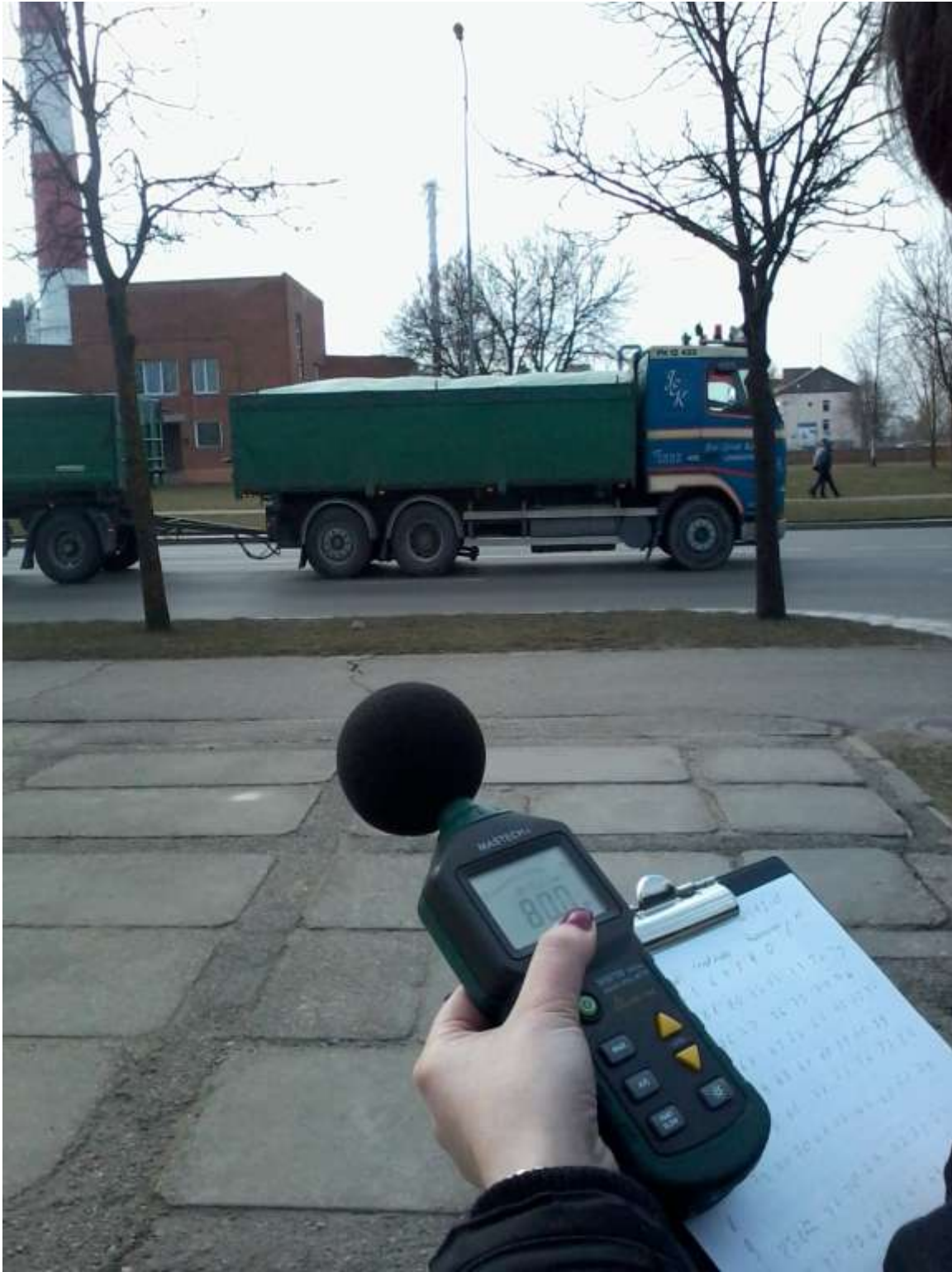
4 pav. Autotransporto keliamo triukšmo matavimai
